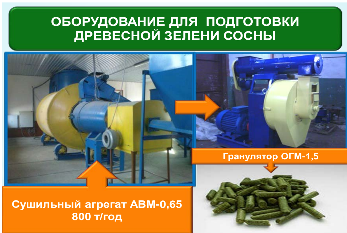
Рис. 4. Оборудование для сушки и грануляции древесной зелени при получении хвойно-витаминной муки
