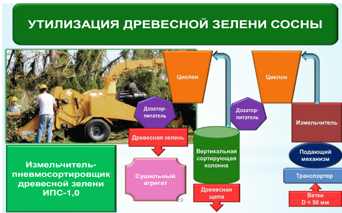
Рис. 3. Технологическая схема подготовки древесной зелени для получения хвойно-витаминной муки
