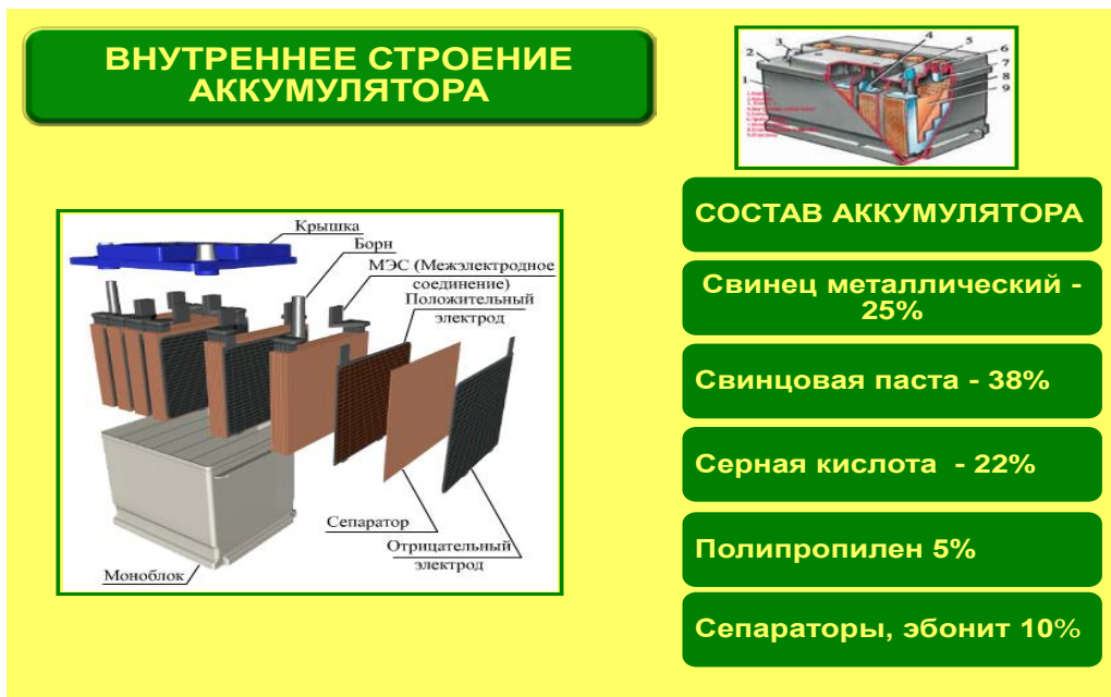
Рис. 2. Внутреннее строение и состав свинцового аккумулятора
