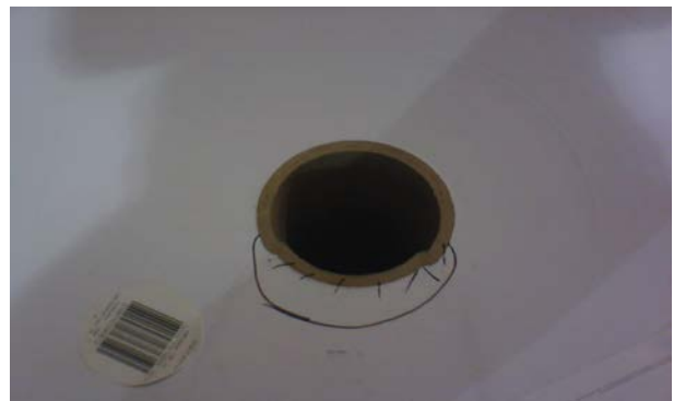
Рис. 8. Рулон с деформированной гильзой
