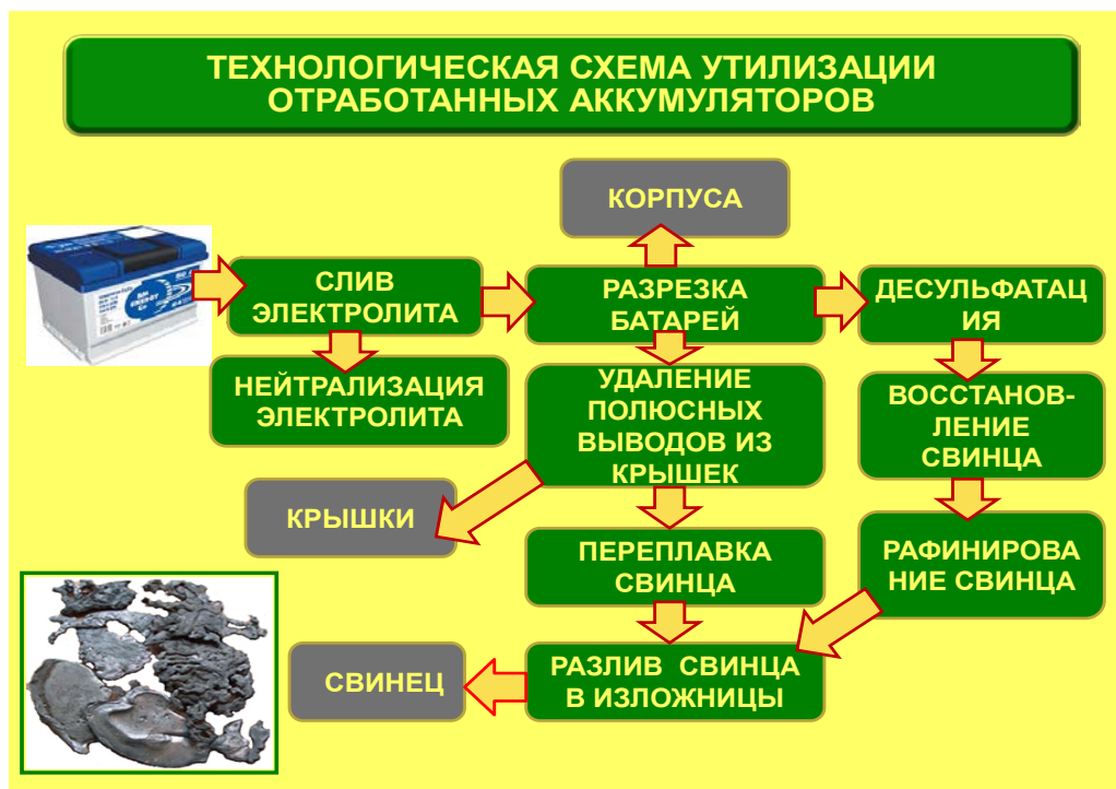
Рис. 6. Технологическая схема утилизации отработанных аккумуляторов
