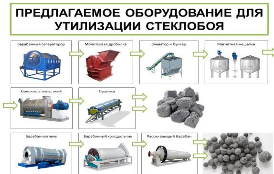
Рис. 4. Оборудование для утилизации стеклобоя
