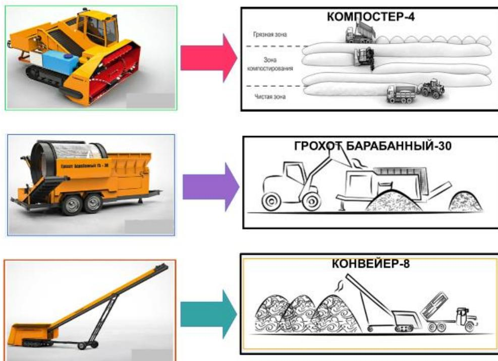
**Рис. 3.** Установки, используемые для компостирования пищевых отходов
