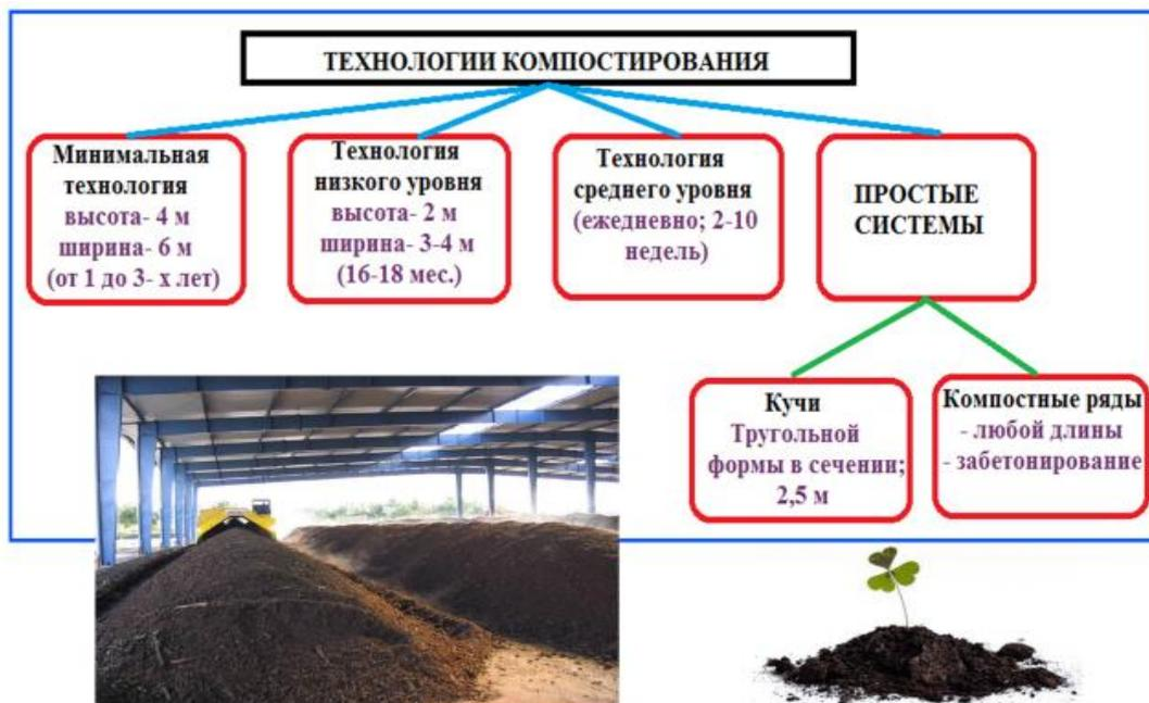
Рис. 2. Технологии компостирования пищевых отходов
