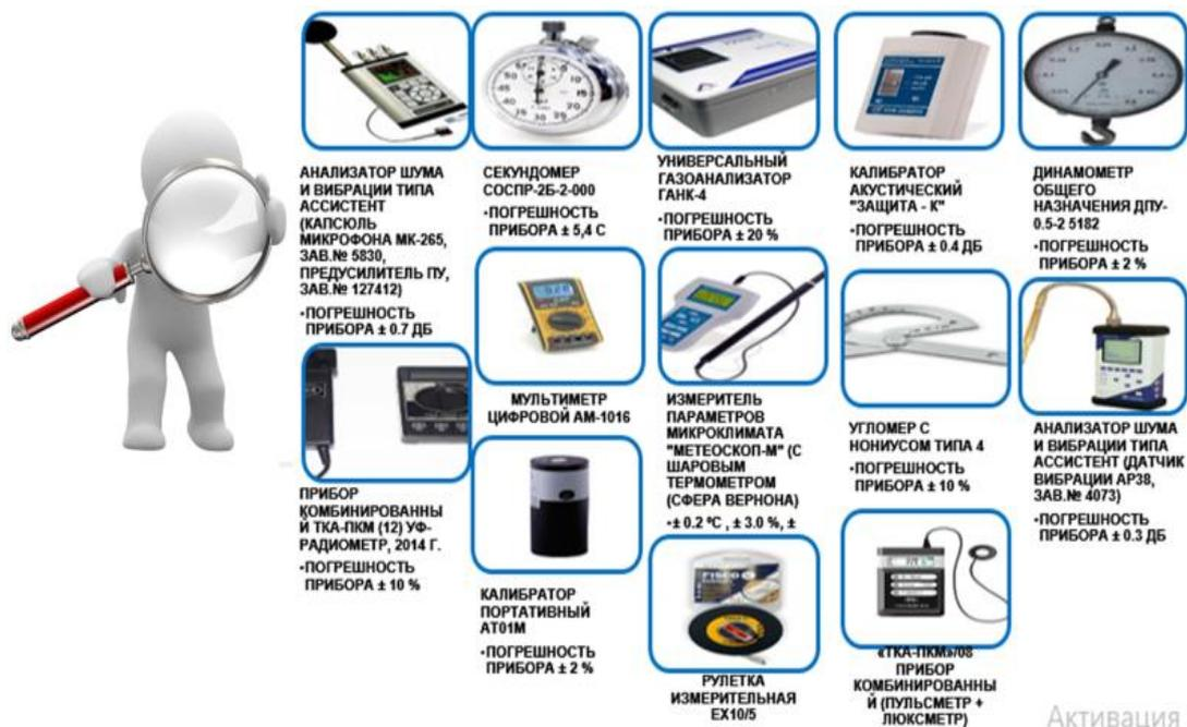
**Рис. 4.** Средства измерений, используемые для проведения СОУТ рабочих мест ОАО «Сыктывкарский Водоканал»
