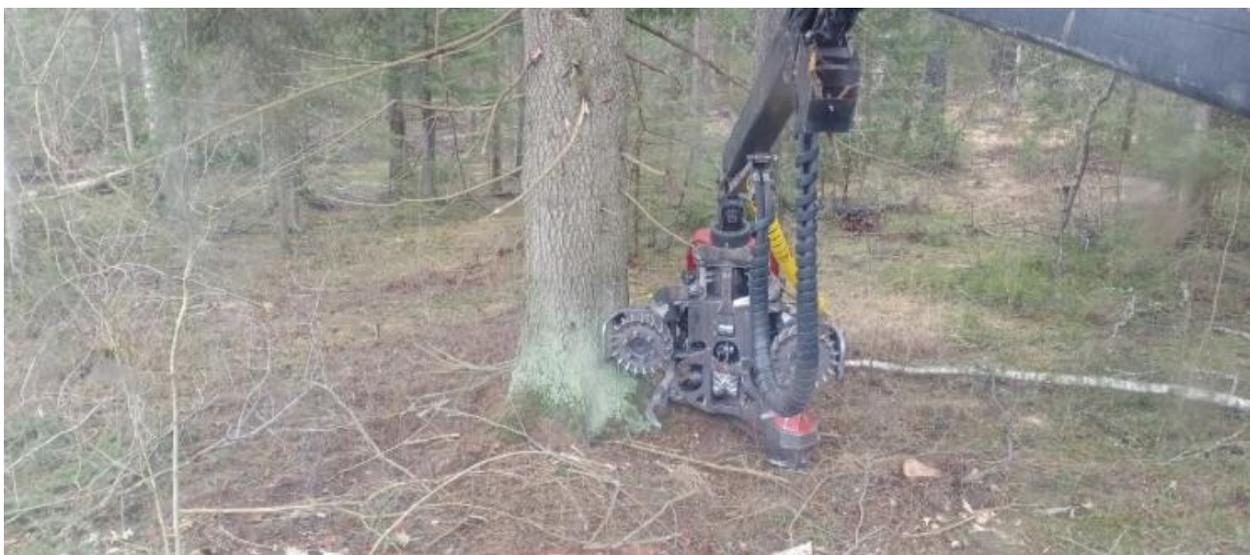
Невозможность валки крупномерных деревьев существующей техникой для заготовки древесины в СЗФО РФ из-за таксационных характеристик лесосек
