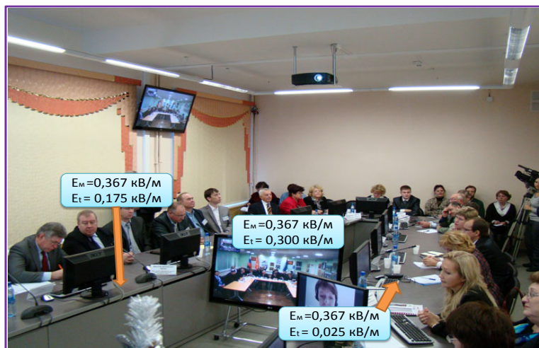
Рис. 6. Результаты измерений электростатического поля компьютеров в ауд. 320-1
