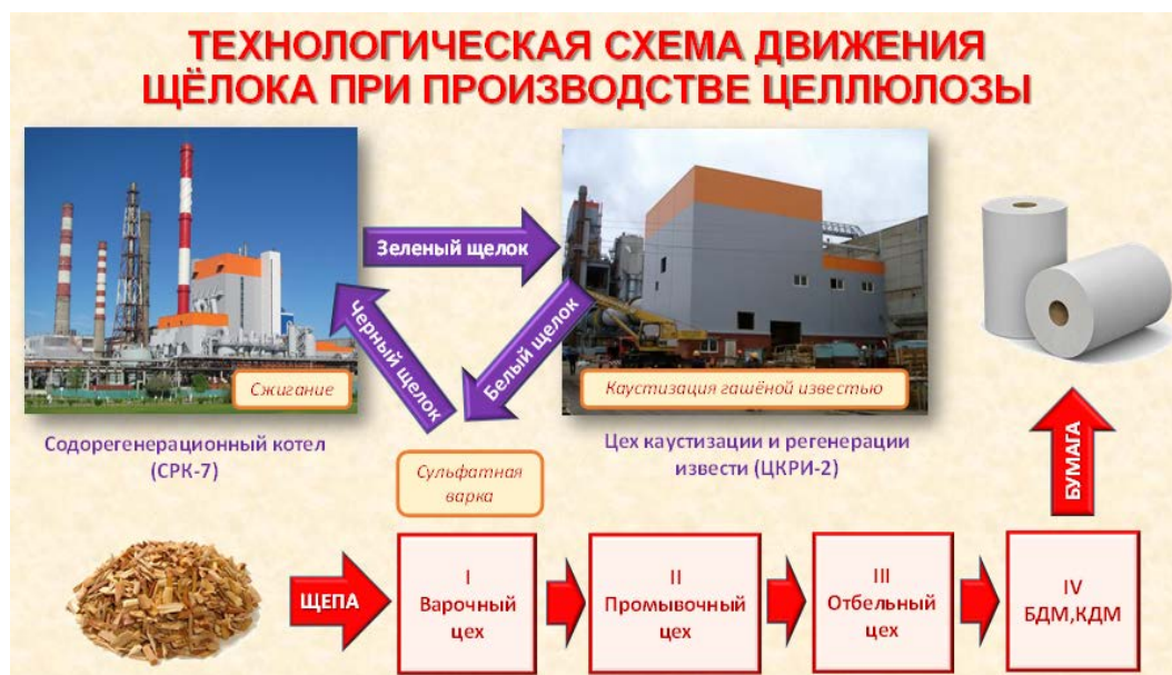
Рис. 1. Технологическая схема движения щелока при производстве целлюлозы в ОАО «Монди Сыктывкарский ЛПК»
