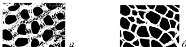
Микрофотограммы поперечного среза (увеличение в 200 раз): a — древесина березовая; б — уголь из древесины березовой
