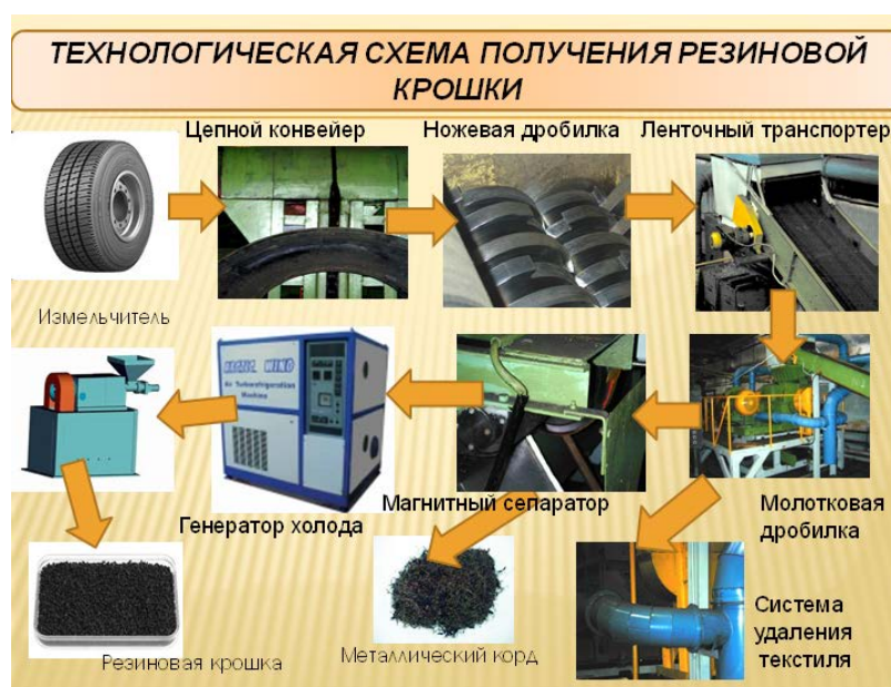
Рис. 3. Технологическая схема получения резиновой крошки
