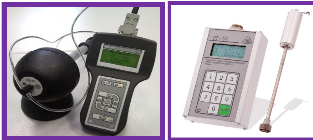
Рис. 3. Приборы для измерения электромагнитного излучения (ВЕ-50) и электростатического поля (СТ-01)
