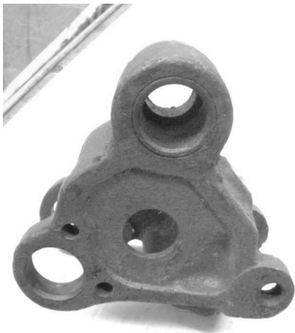
**Рис. 2.** Блок шарниров трелевочного трактора
