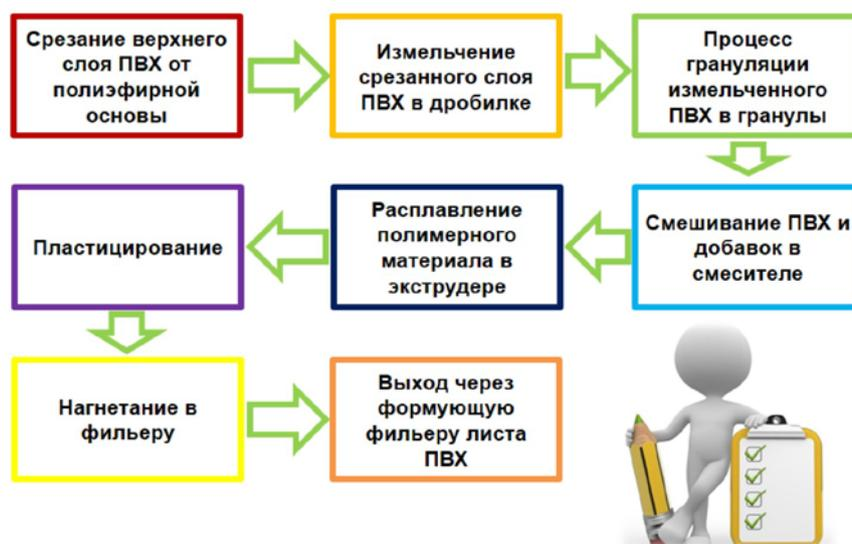
Рис. 3. Технологическая схема утилизации отходов линолеума
