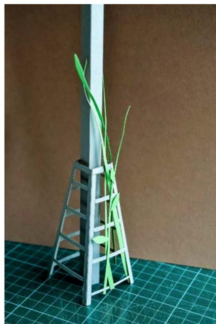
Рис. 3. Макет маскировочного каркаса для опор ЛЭП
