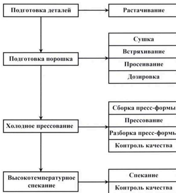
**Рис. 3.** Технологический процесс восстановления
