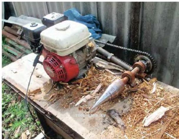
**Рис. 1.** Мобильная установка для колки дров
