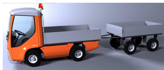
Рис. 3. Вариант исполнения УМТЭТ в качестве тягача
