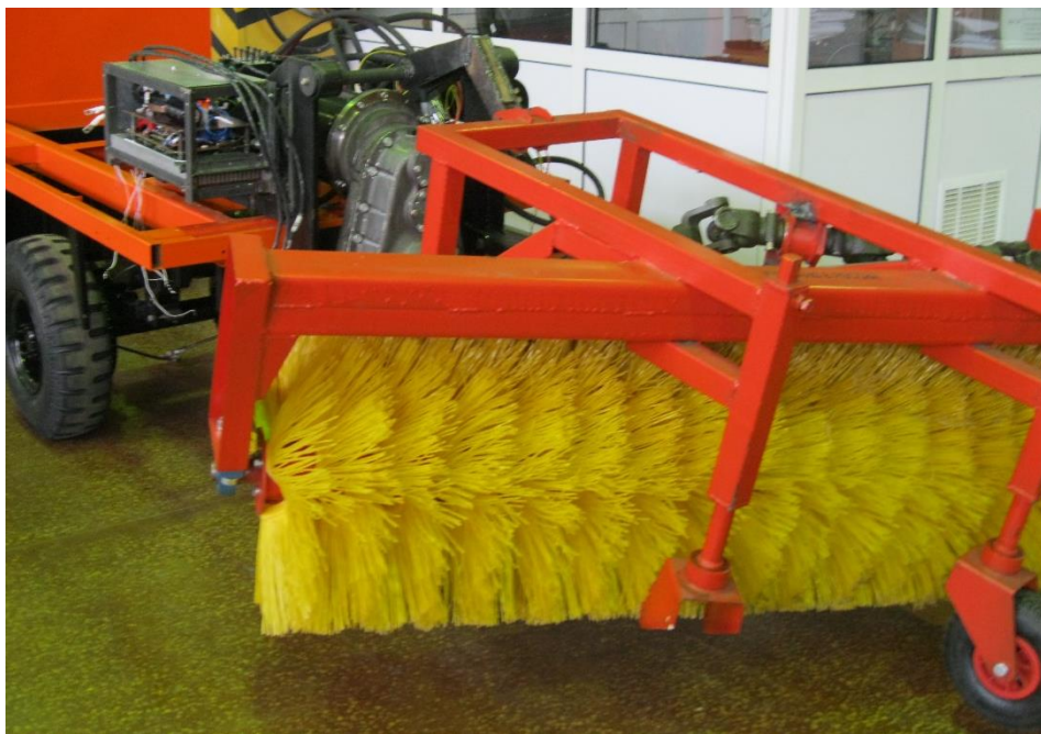
Рис. 4. Внешний вид роторной щетки, установленной на шасси УМТЭТ для экспериментальных исследований
