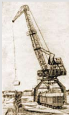
Импортный порталый кран «Ганц» грузоподъёмностью 5 тонн. Сыктывкарский ЛДК.
