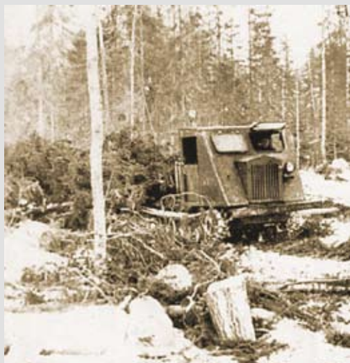
Трелёвка леса тракторами ТДТ-40. Такая техника работала с начала 1950-х гг. до конца 1970-х гг.
