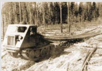
Трелёвка леса трактором КТ-12, использовались до 1955 г.
