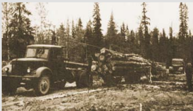
Погрузка леса на машину марки МАЗ-501 с агрегатной установкой ЛК-13 на лесной делянке в Рыбницком лесопункте Кожвинского леспромхоза. Печорский р-н. 1968 г.
