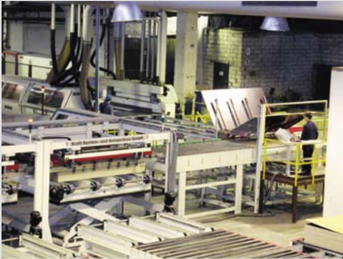
Автоматическая линия раскроя и сортировки фанеры обеспечивает нужный формат, нарезает кромку и автоматически кладёт продукцию в соответствующую пачку; человек занят только визуальным контролем качества.
