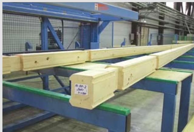
Клеёный профилированный брус с резками под проект дома.
