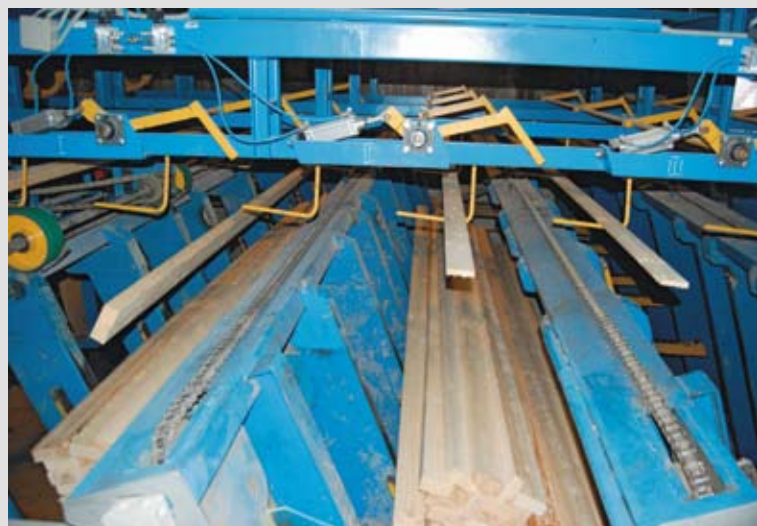
Линия сортировки досок компании-производителя «Gunnarssons».
