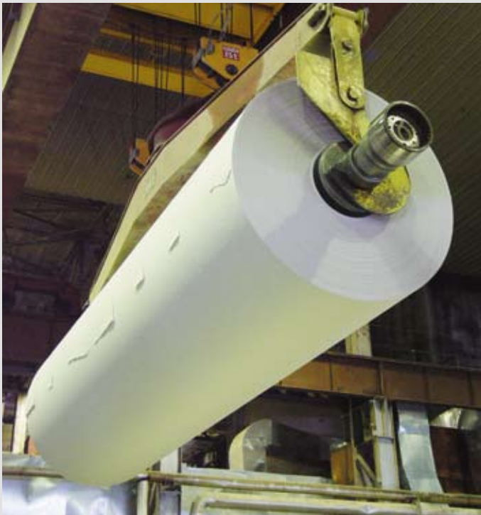
Еще тёплый рулон высококачественной бумаги краном сняли с наката.
