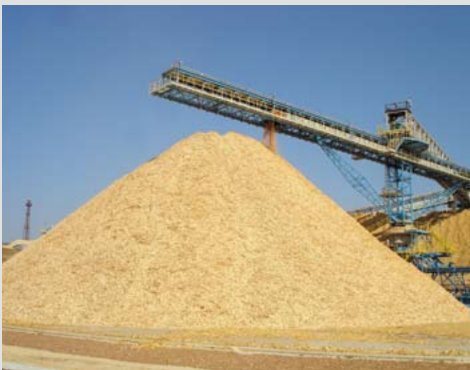
В рамках проекта «Степ» на ОАО «Монди СЛПК» внедрена принципиально новая система хранения и подачи щепы. Работа оборудования по принципу «первая пришла -- первая ушла» обеспечивает высокое качество целлюлозы и готовой продукции.
