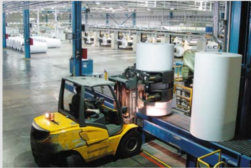
Цех листовых бумаг № 2. Погрузчик снимает материнский рулон с транспортёра, чтобы подать его на резательный станок.
