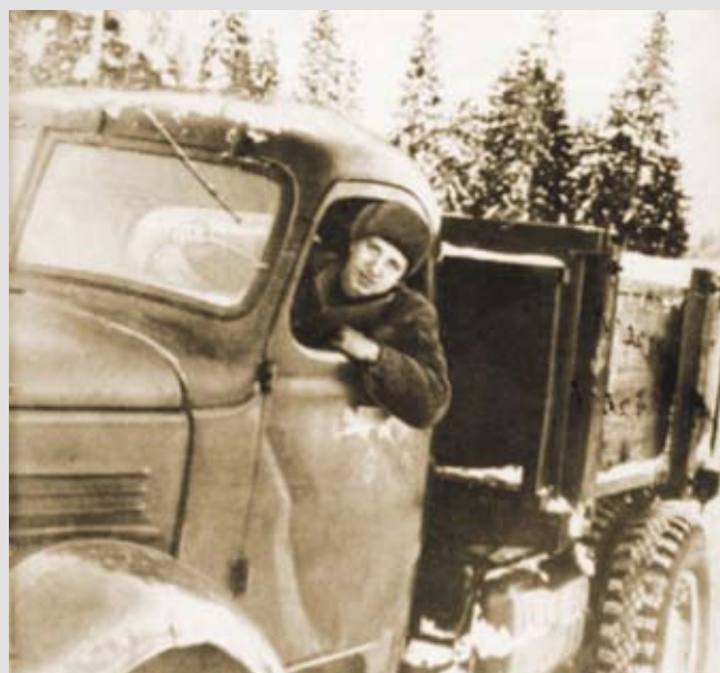
Автополивщик системы Штаппера. Применялся для поливки лесовозных дорог в зимнее время. 1957 г.
