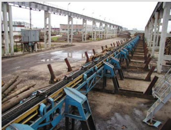
Линия сортировки брёвен ЛТ-182.
