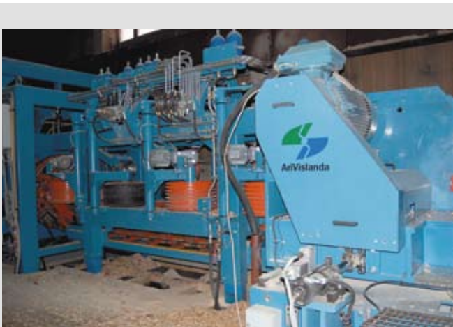
Лесопильная линия компании-производителя «AriVislanda».
