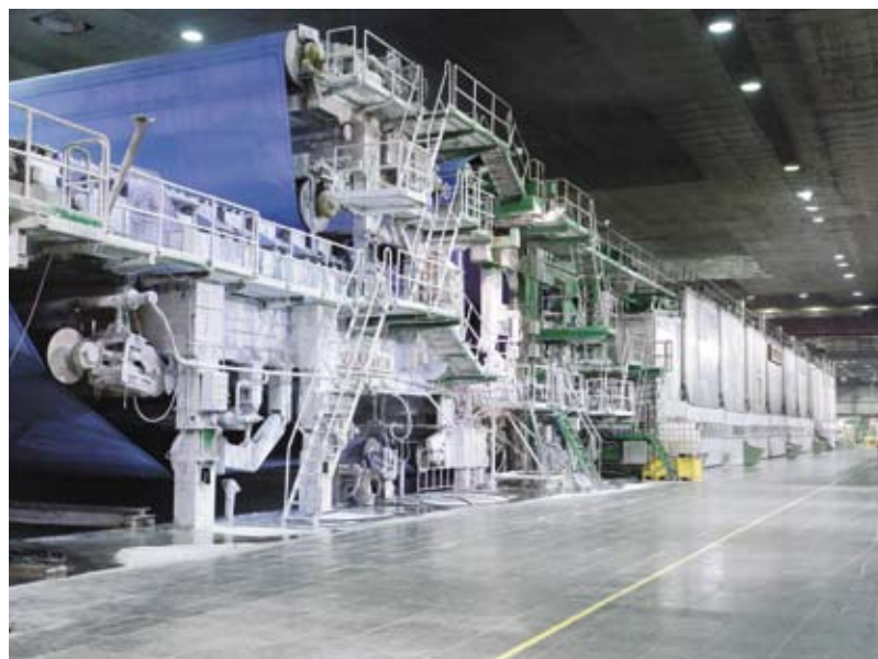
Бумагоделательная машина № 14 после реконструкции в рамках проекта «Степ».
